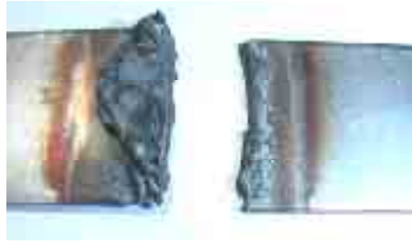
Figura 8 - Solda de topo, em corpo de prova sem a utilização do gás de proteção.
