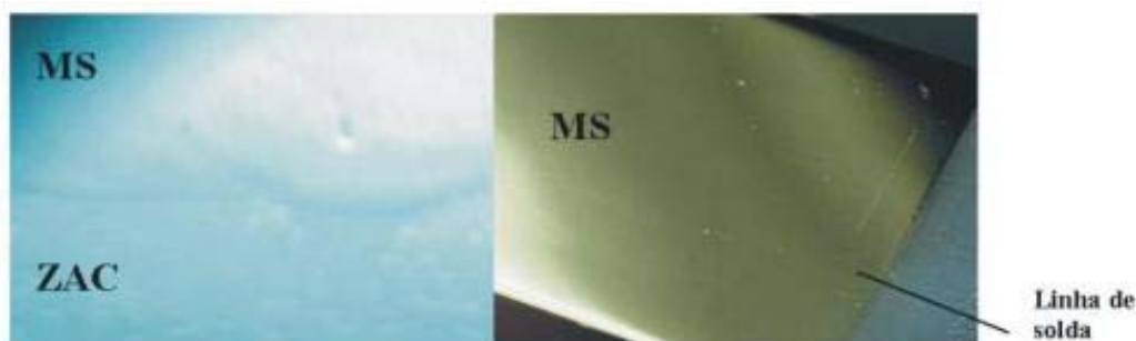
Figura 5. Relevo na região do MS na soldagem do aço VP50IM, observado através da refletância da luz: a) soldagem com MA dissimilar; b) soldagem com MA similar.
