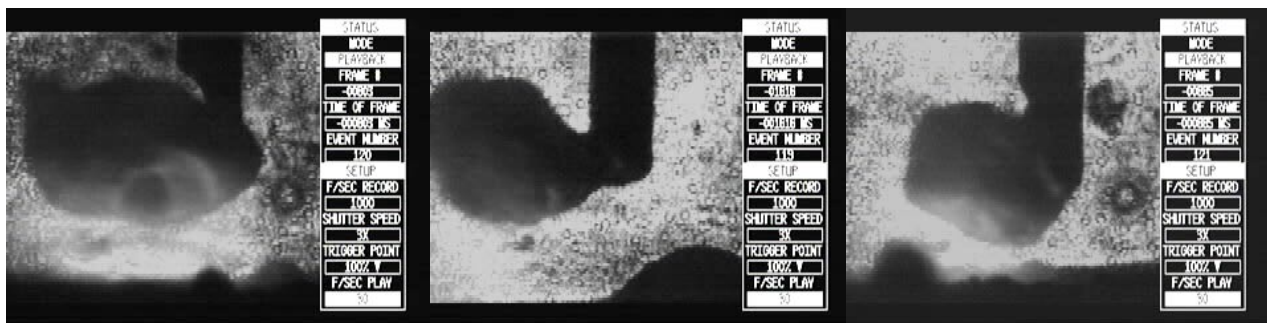
Figura 5. Quadros típicos das filmagens da soldagem do arame “metal cored” com 100%CO 2 .
