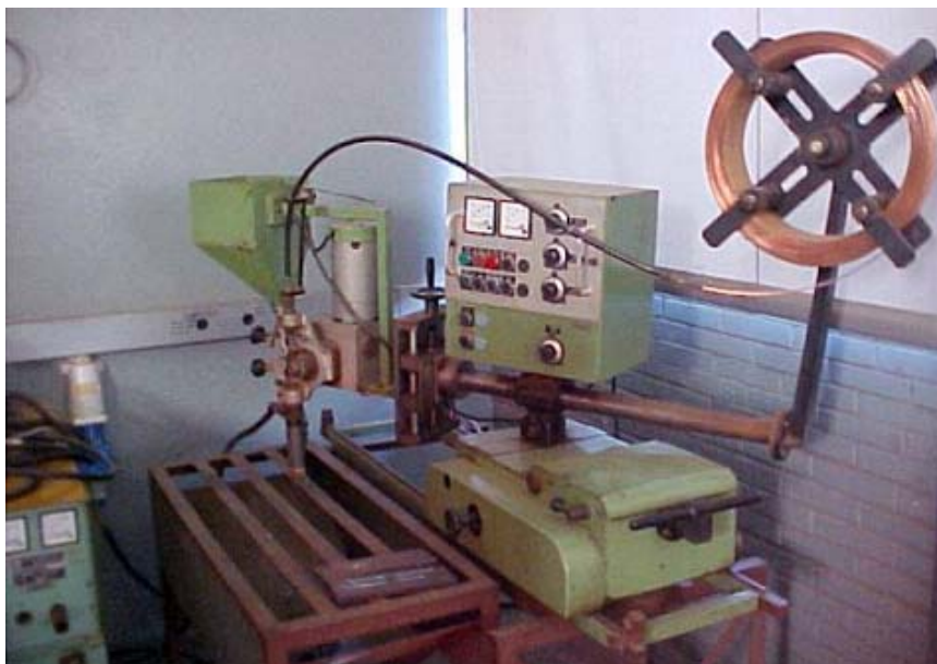
Figura 6 – Equipamento utilizado para a soldagem em Arco Submerso
