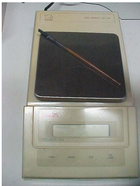
Figura 4 – Medição da massa do eletrodo de grafite após o experimento.
