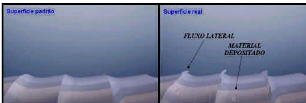
Figura 1. Comparação da superfície teórica com a superfície real obtida em operações de torneamento<sup>(6)</sup>.
