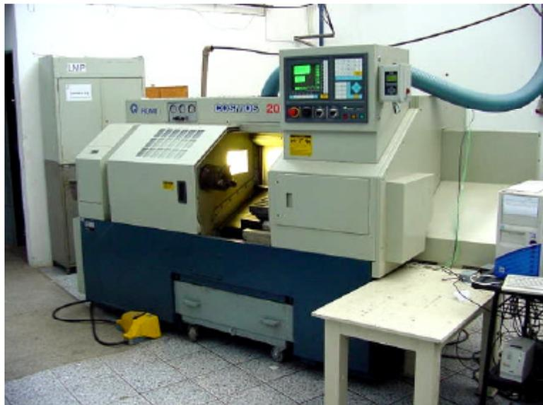
Figura 2. Torno CNC usado nos ensaios
