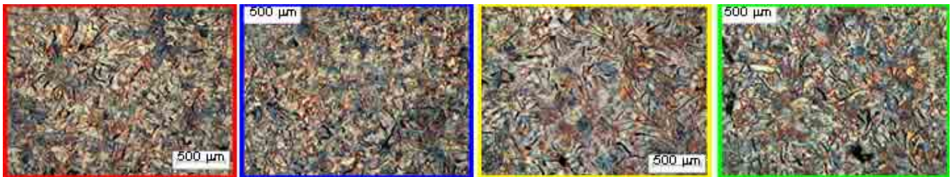
Figura 3 - Perlita no ferro fundido cinzento FC 25 com 0,065%, 0,12%, 0,15% e 0,18% de enxofre.
