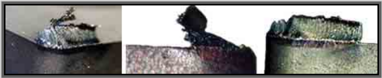
Figura 9- Adesão na face da ferramenta de metal duro sem cobertura (0,065% S e v_c = 150 m/min).
