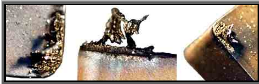
Figura 10 - Adesão na face da ferramenta de metal duro com cobertura (0,065% S e v_c = 150 m/min).
