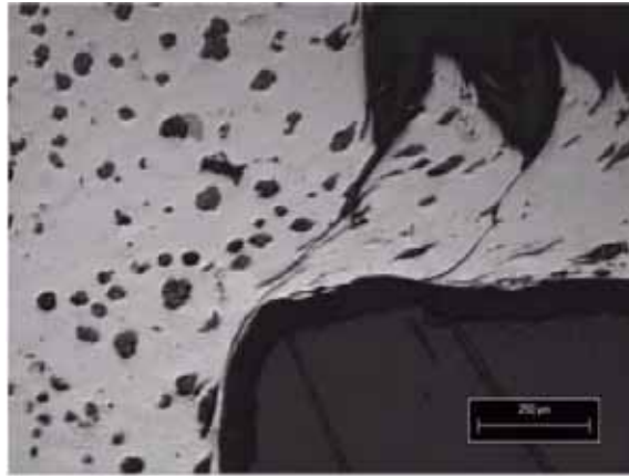
Figura 7. Seção da raiz do cavaco do ferro fundido nodular ferrítico (condições de corte: v_c = 80 m/min f = 0,2 mm e a_p = 2 mm)
