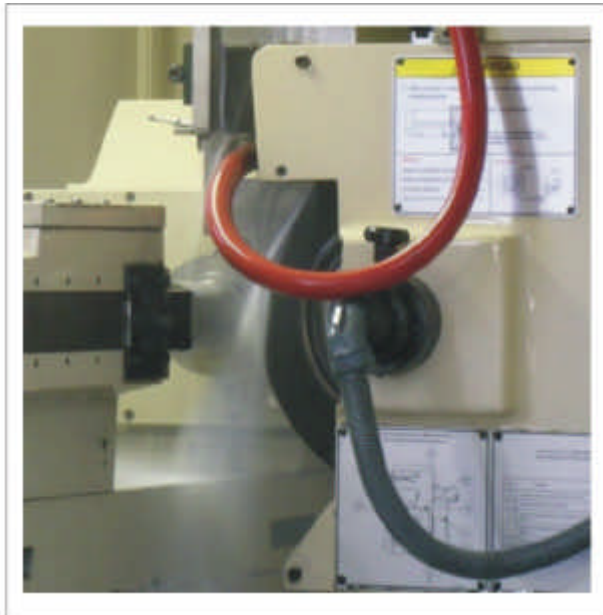
Figura 8. Segundo ensaio (Tubeira tipo Sapata).
