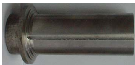
Figura 2. Barra cilíndrica feita com o aço ABNT 1045
