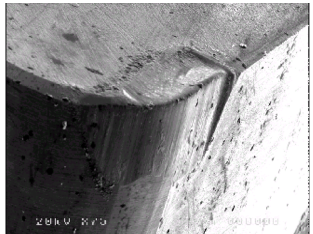
(d) CC650 ( v_c=250 m/min, f=0,1 mm e a_p=0,5 mm).
