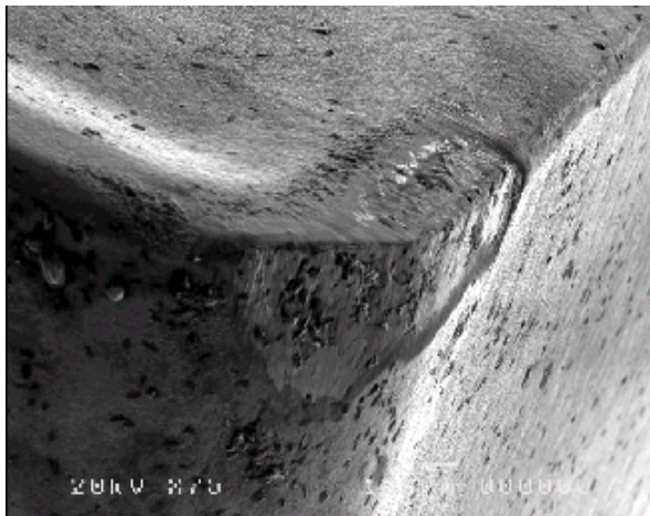
(c) KM ( v_c=250 m/min, f=0,1 mm e a_p=0,5 mm).
