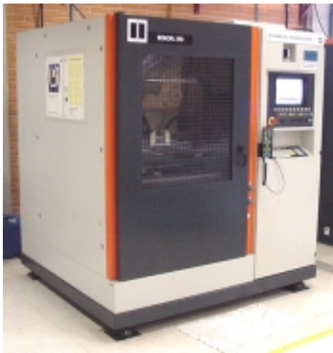
Figura 3. Máquina de WEDM utilizada nos testes.
