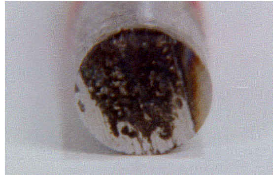
Figura 11- Detalhe da superfície após sofrer descargas elétricas em condições agressivas.
