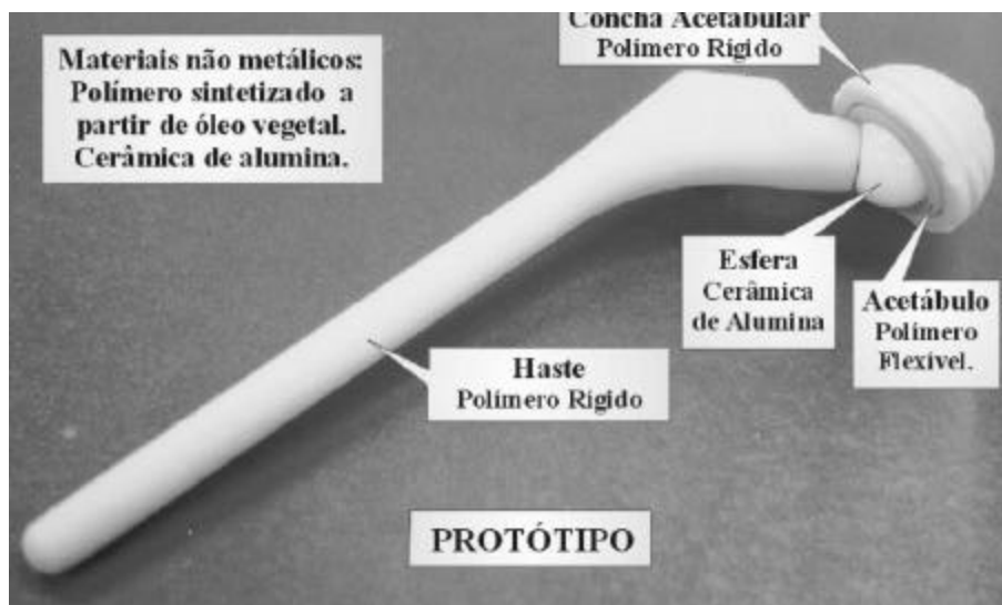
Figura 1 – Protótipo do implante de quadril em cerâmica e polímero.
