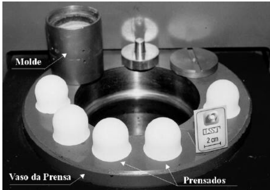
Figura 1- Prensagem isostática de esferas de cerâmica.
