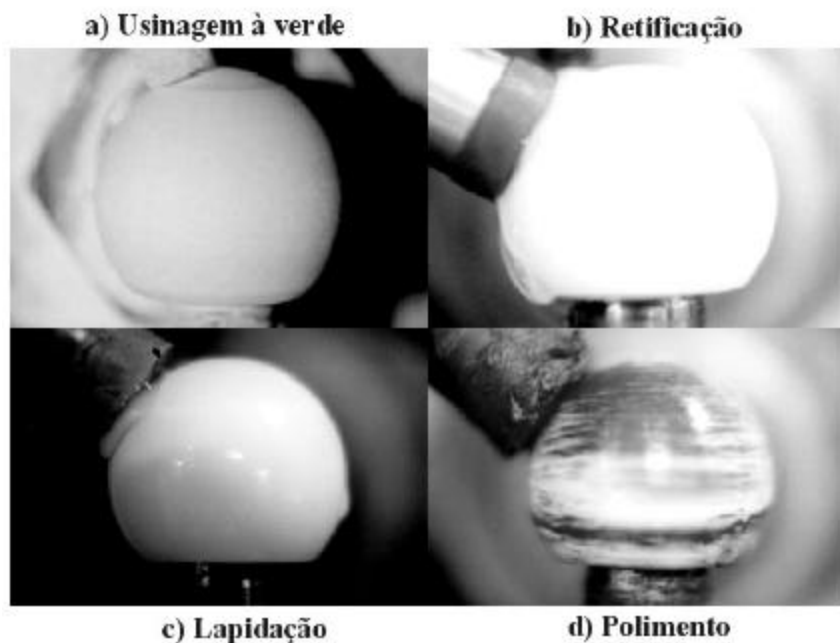
Figura 2- Usinagem das esferas de cerâmica nas várias etapas de fabricação.
