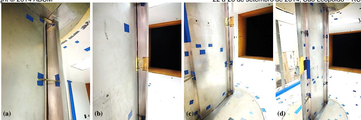
Figura 5 – Vista do intradorso do modelo contendo os selos na cova do eslate. Posições: (a) 8 [mm], (b) 17,5 [mm], (c) 30,5 [mm] e (d) 45 [mm].
