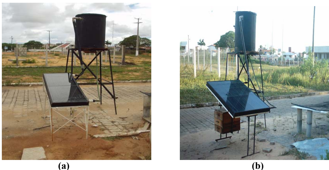
Figura 1. Sistemas de aquecimento em teste: (a) utilizando coletor alternativo e (b) utilizando coletor convencional.
