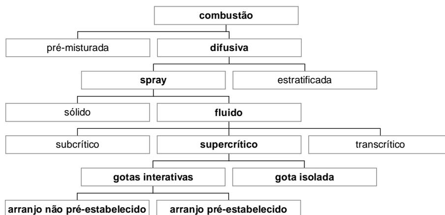
Figura 1.4. Posicionamento dos principais grupos de problemas de combustão supercrítica de gotas e de *sprays* no âmbito da Teoria de Combustão.
