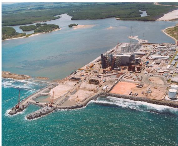
Figura 6. Fase de construção do aterro de areia para os trabalhos de derrocagem dos arrecifes.
