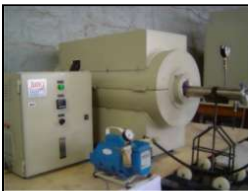
Figura 02. Forno utilizado na sinterização das amostras ferro puro.
