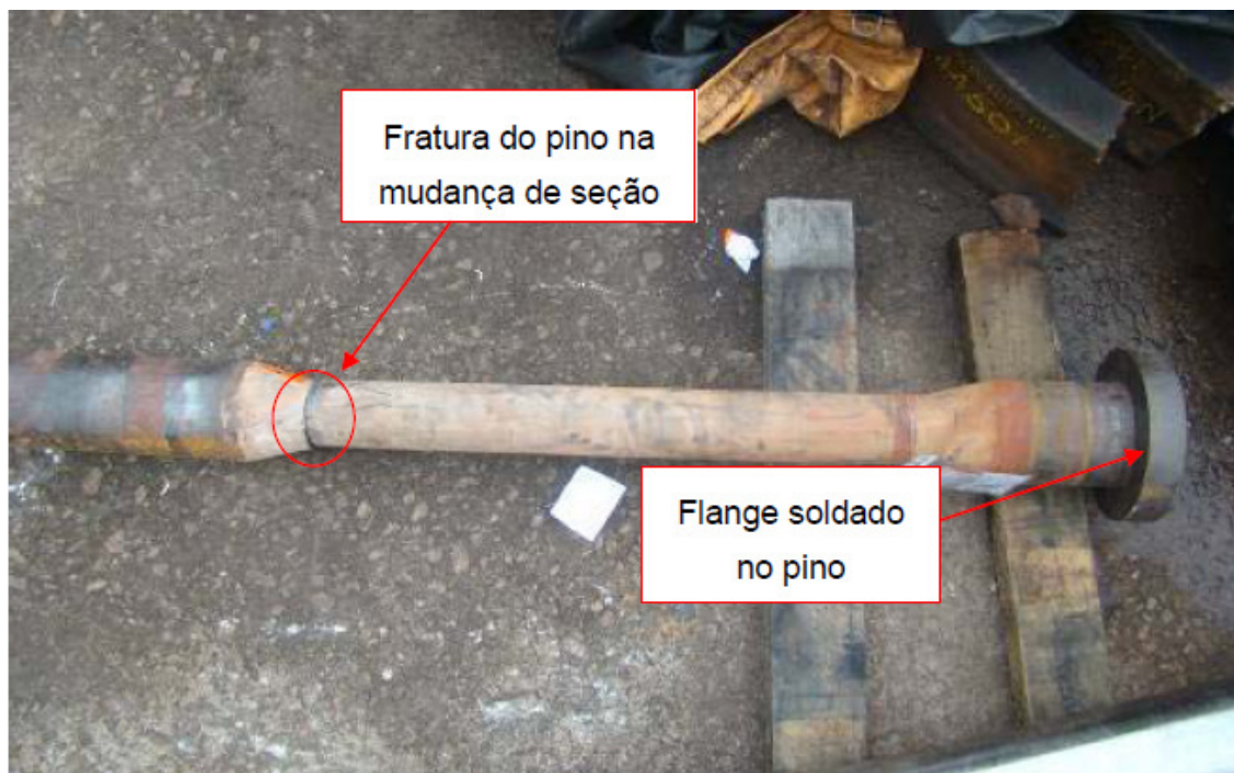
Figura 5. Pino fraturado enviado para análise.
