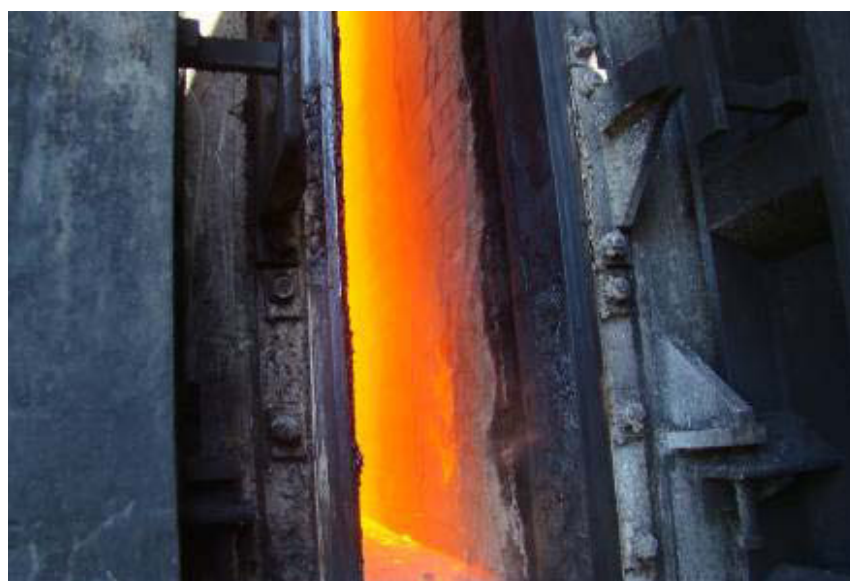
Figura 8. Porta de entrada de um forno da coqueria.
