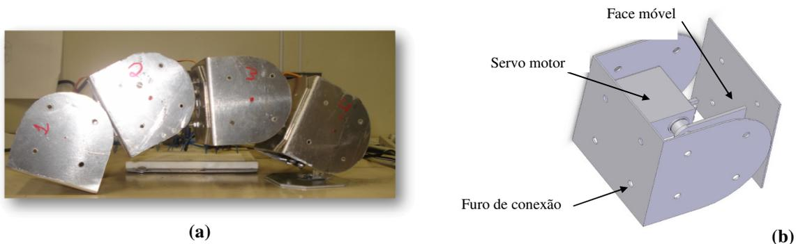
Figura 5. Módulos Erekobot  $\beta$ -5 (a) conectados em série, em configuração ponte; (b) detalhe de um módulo.
