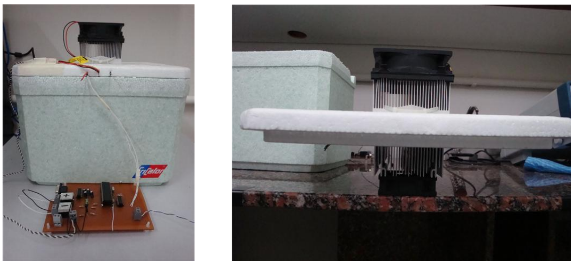
Figura 5. Sistema ventoinha-dissipador-Peltier-dissipador-ventoinha instalado na tampa da caixa e detalhe do sistema na tampa da caixa.
