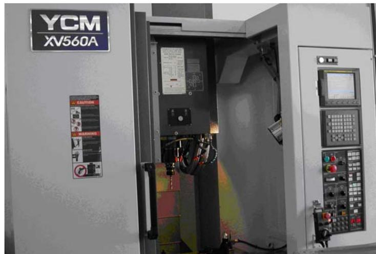
**Figura 1. Centro de usinagem utilizado no procedimento de furação.**
