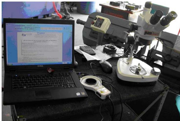
**Figura 3. Sistema de capturação das imagens das brocas durante o ensaio de desgaste por usinagem.**
