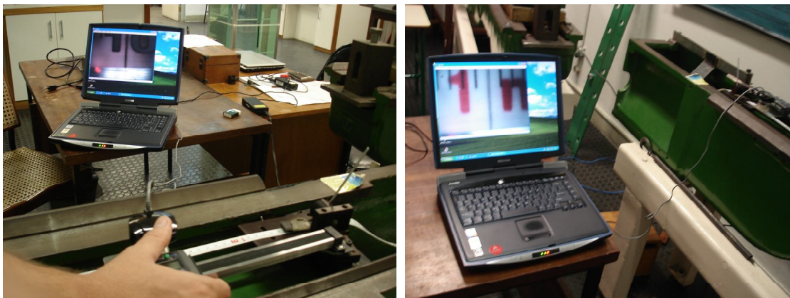
Figura 6. Implantação da câmera, substituindo a lupa e gerando imagens no computador
