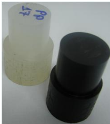
Figura 1. Detalhe dos corpos de prova de NYLON e POM
