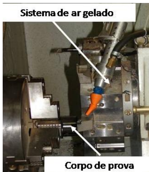
Figura 3. Detalhe do set-up do experimento utilizando o sistema de ar gelado
