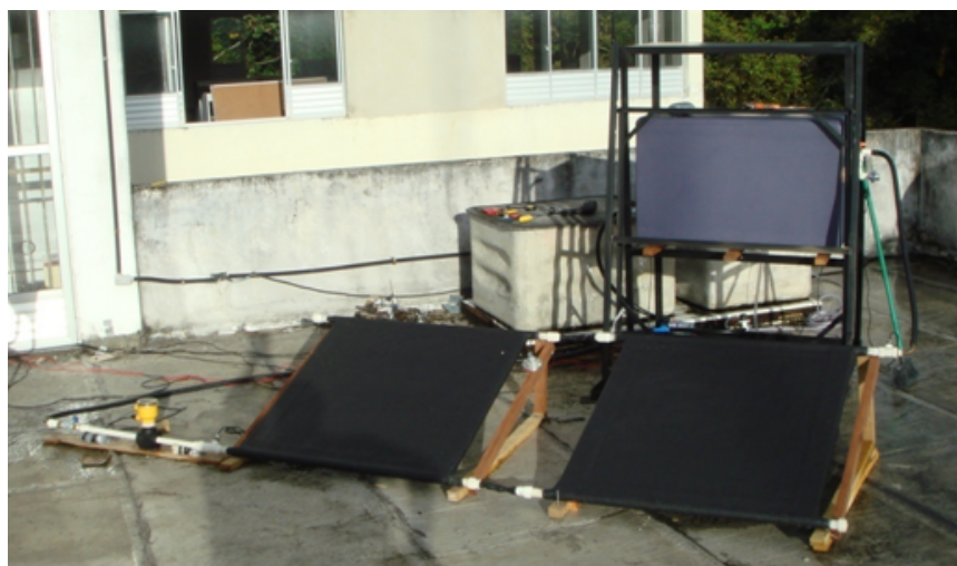
Figura 2. Sistema de aquecimento de água por energia solar (bancada de teste).
