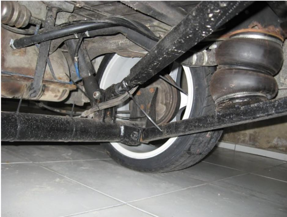
Figura 2. Bolsa de ar fixa no eixo 4-link em Pickup.
