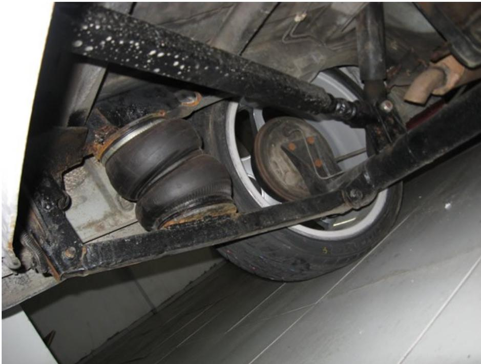
Figura 3. Eixo 4-link com a bolsa de ar de borracha.
