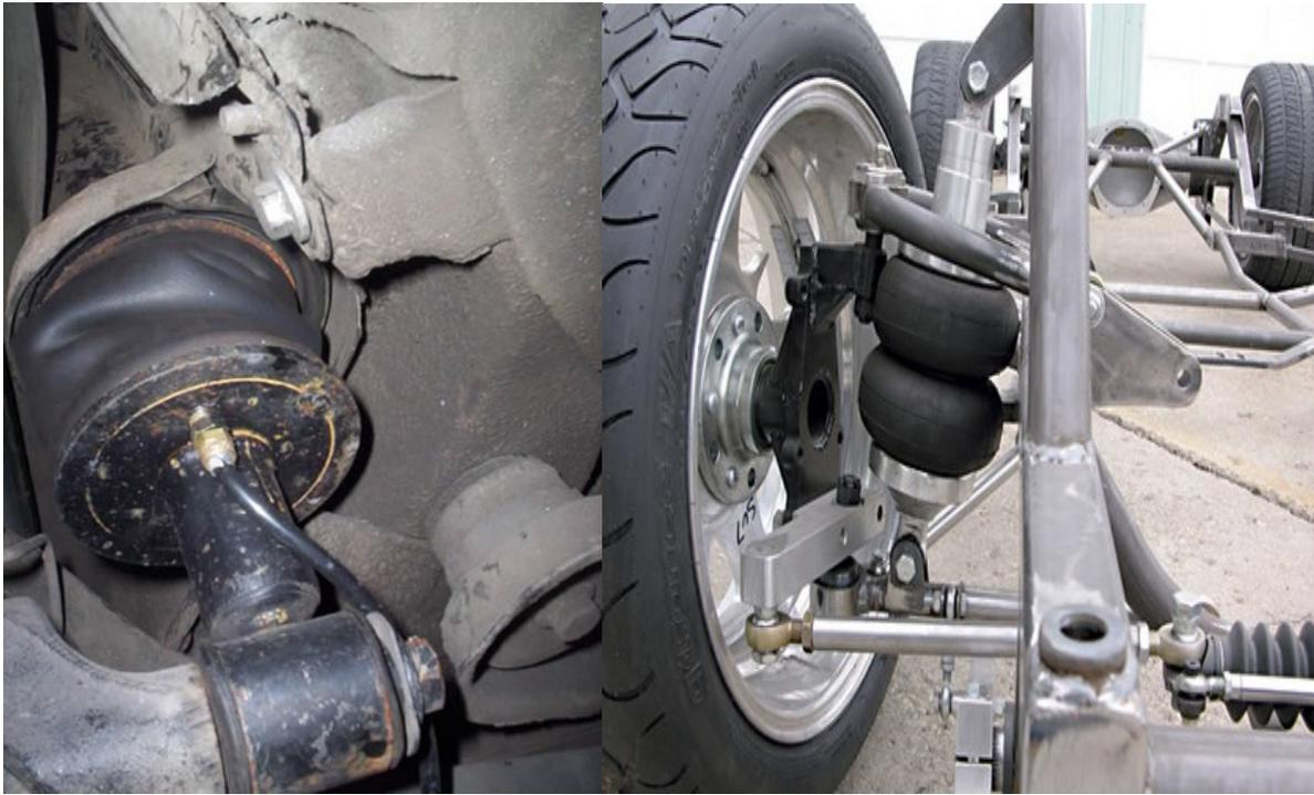
**Figura 4. Bolsa de ar fixa na parte dianteira do automóvel.**
