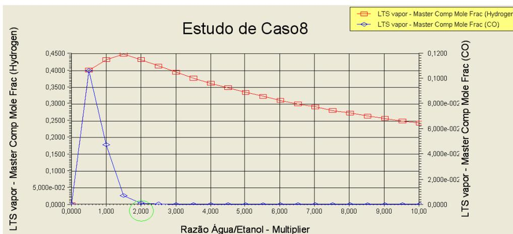
Figura 7. Fração Molar dos Componentes de H<sub>2</sub> e do CO na Saída do Reator LTS em Função da Razão Água/Etanol
