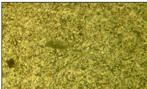
**Figura 3 – Microscopia óptica da superfície do diamante CVD crescido à 600°C**
