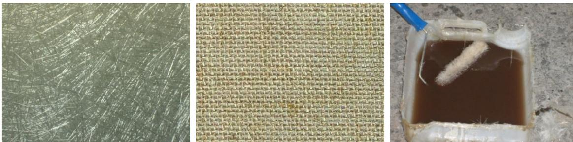
**Figura 1. Materiais utilizados nos compósitos: Manta de fio picado de vidro E, Fibra de Juta, Resina poliéster Tereftálica.**
