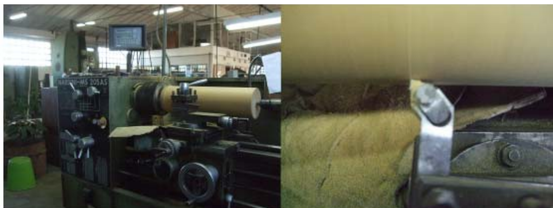
Figura 3. Detalhes da montagem e atuação da ferramenta durante os testes de usinagem.
