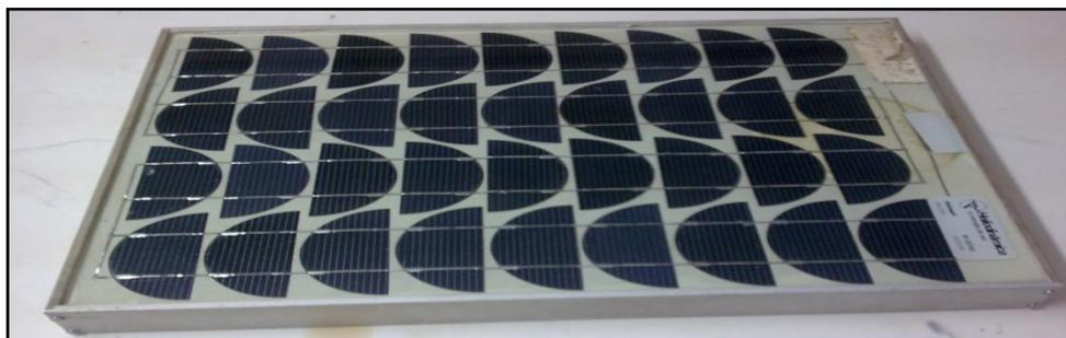
Figura 1. Módulo de Silício Monocristalino
