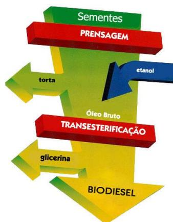
Figura 1. Processo de produção de biodiesel
