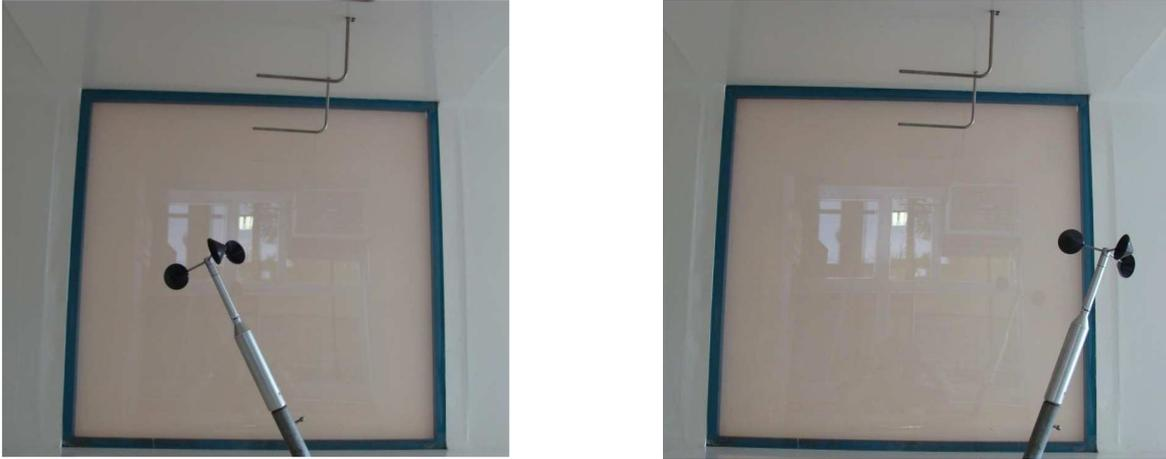
Figura 5. Anemômetro em seção de teste do túnel de vento em diferente posição angular.
