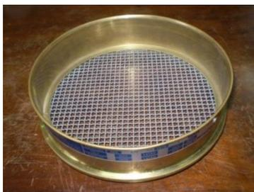
Figura 3: Peneira para o teste granulométrico dos caroços de açaí.
