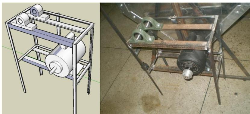
Figura 8: *layout* do suporte do motor.
