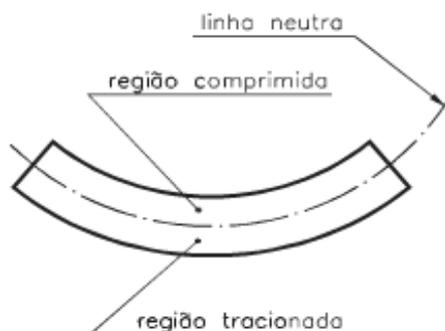
Figura 3 - Viga flexionada
