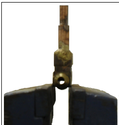
Figura 7 - Fixação dos sensores de temperatura.
