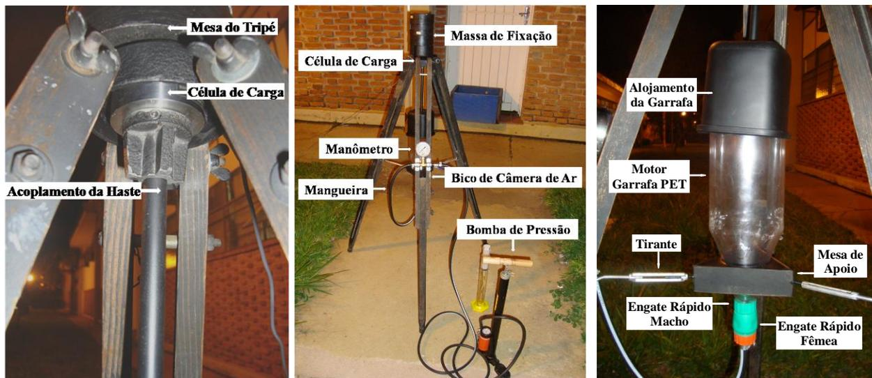
Figura 3. Balança, célula de carga e detalhes do motor.
