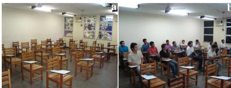
Figura 6 - Sala analisada durante medição de tempo de reverberação (a) sem audiência e (b) com audiência.
