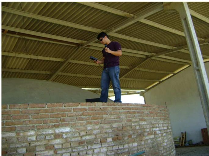
Figura 3. Medição da velocidade do vento local.
