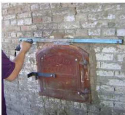
Figura 4. Medição da emissividade da parede.
