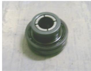
Figura 14. Rolamento utilizado para indução de defeitos.
