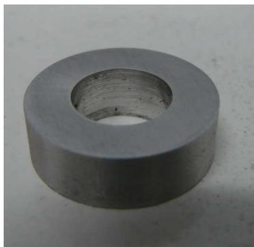
Figura 5. Corpo de prova usinado.
