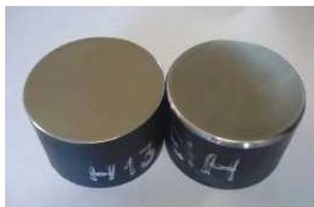
Figura 6. Bases em aço AISI H13.
