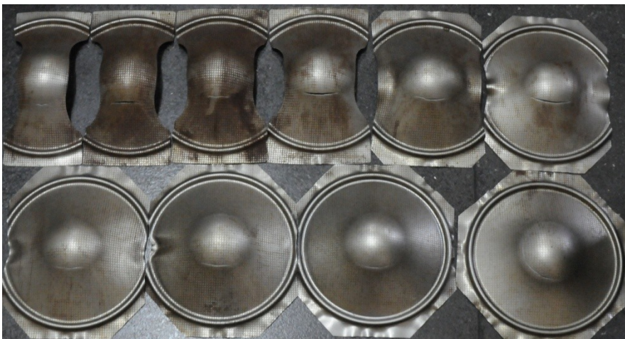
Figura 5 – Corpos de prova deformados através do ensaio Nakazima
