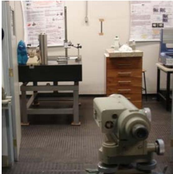
**Figura 6. Nível apontando para primeiro conjunto traçador-relógio comparador.**
