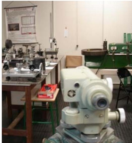
**Figura 7. Nível apontando para segundo conjunto traçador-relógio comparador.**
