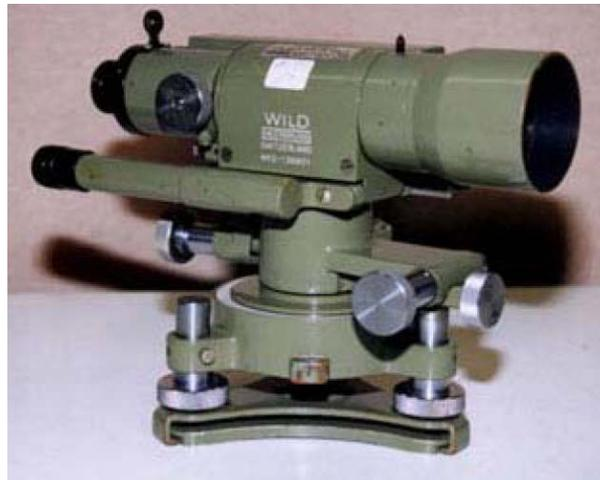
Figura 3. Nível de Linha (*Tilting Level*)
