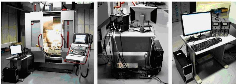
Figura 3. HSM 5 eixos *HERMLE*<sup>®</sup> *C30 Dynamic*, computador e amplificadores.
