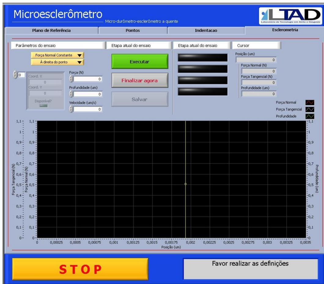
Figura 8. Tela para realização de ensaios de esclerometria
