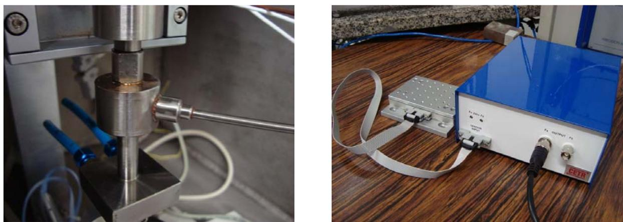
Figura 3. (a) Célula de carga para medição da força axial; (b) célula de carga bidirecional para leitura da força tangencial e condicionador de sinais
