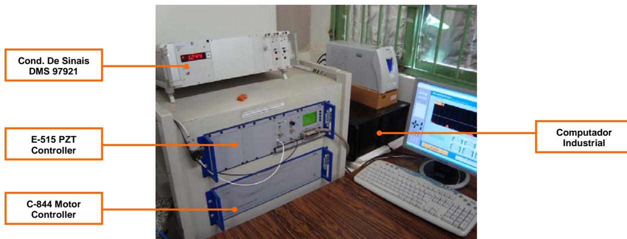
Figura 2. Servocontroladoras, condicionador de sinais e computador industrial aplicados ao microescler metro
