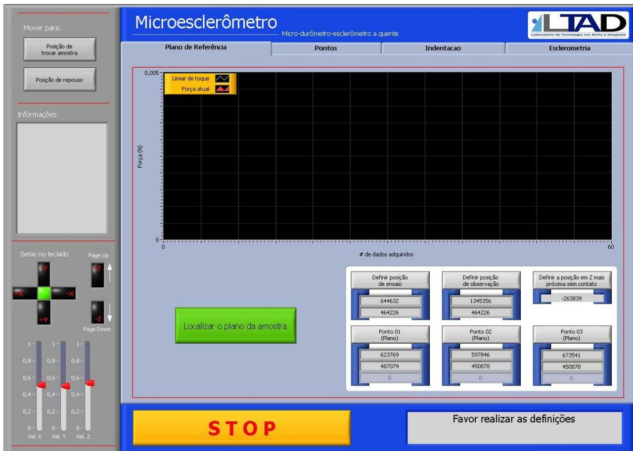
Figura 5. Tela inicial da IHM do programa para ensaios de indentação e esclerometria
