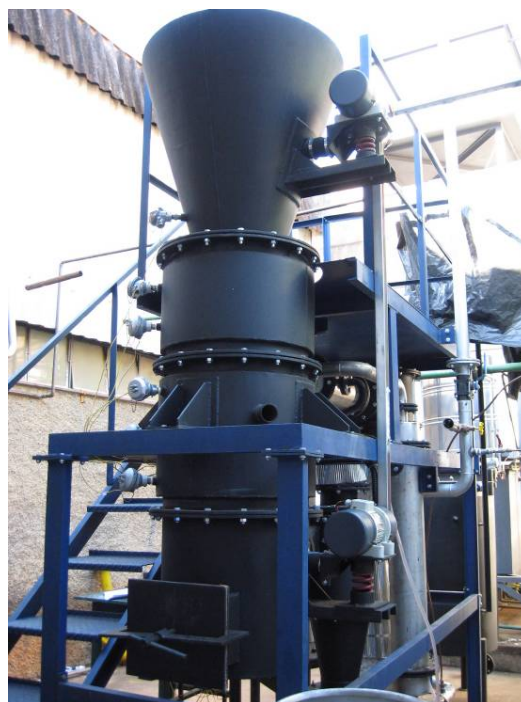
Figura 2.1 – Desenho esquemático e foto do gaseificador
