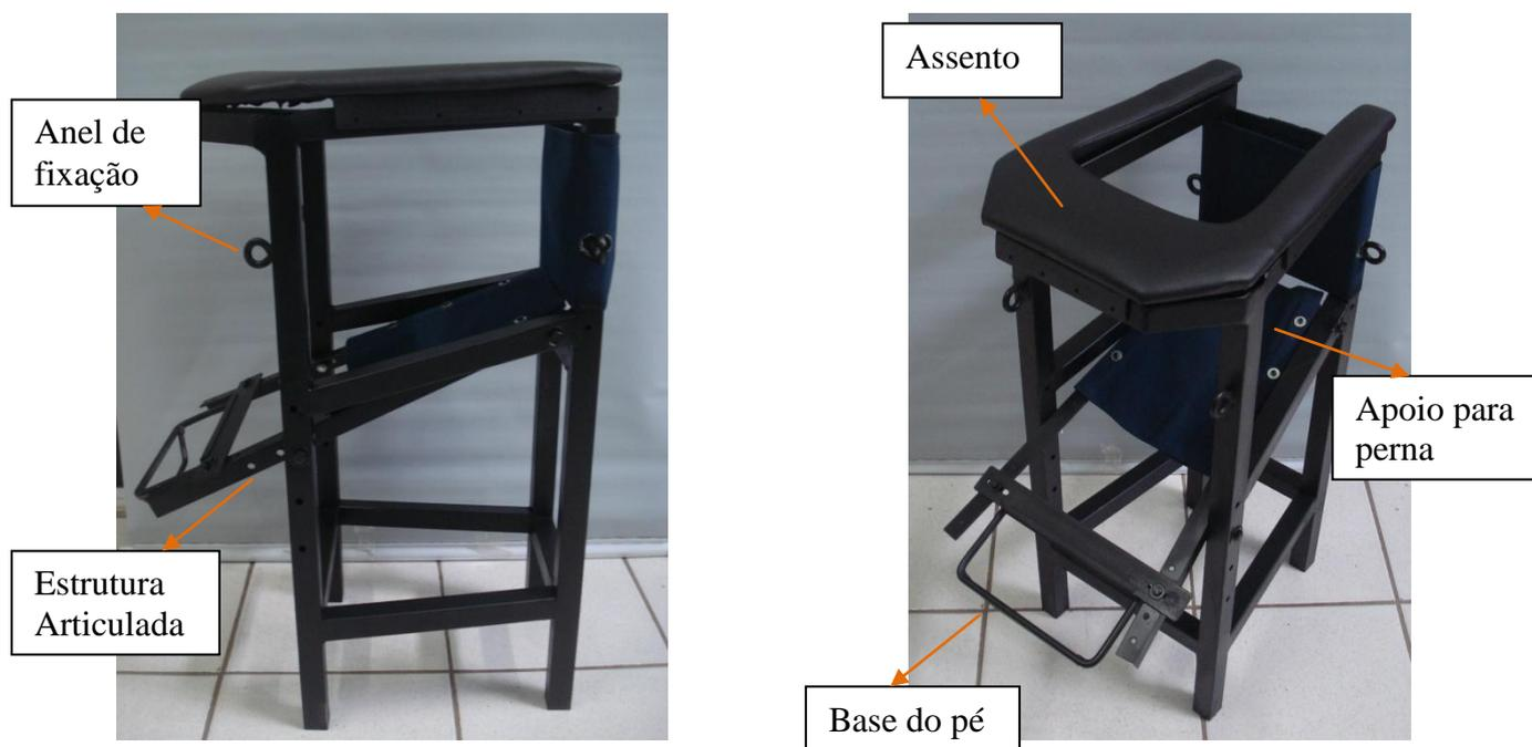
Figura 3. Protótipo da cadeira de arremesso de peso.
