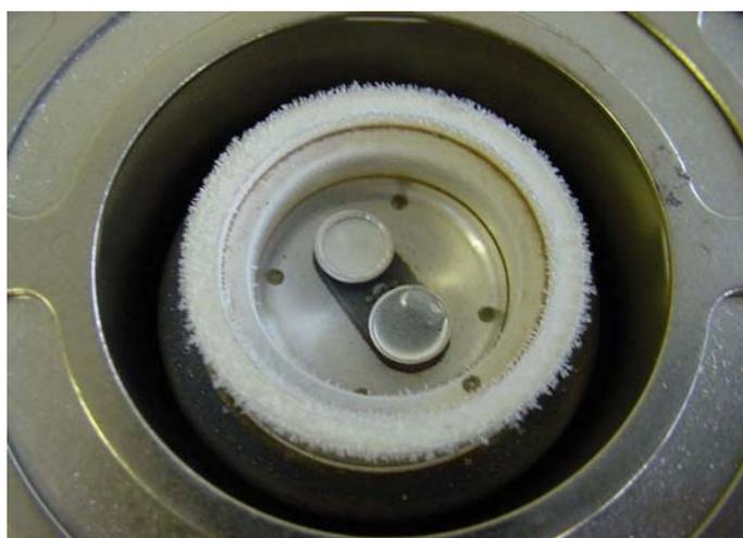
Figura 6. Detalhe dos aquecedores do modelo DSC Q10 com os dois cadinhos
