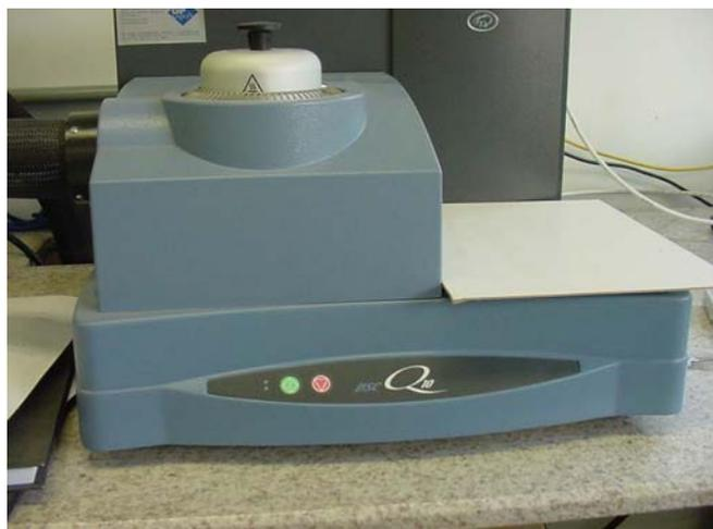
**Figura 3.** Modelo DSC Q10 da TA Instruments para medição de calor específico pelo método DSC.
